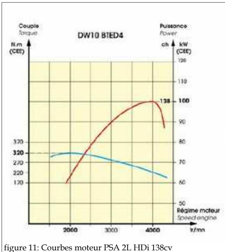
figure 11: Courbes moteur PSA 2L HDi 138cv
