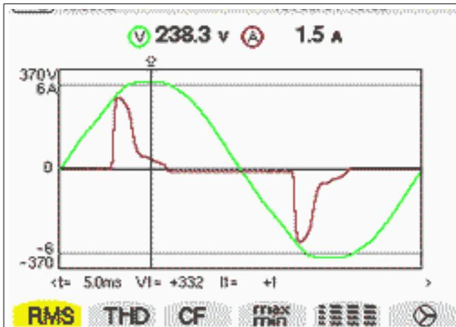
figure 5: chronogrammes tension et courant lampe fluo compacte
