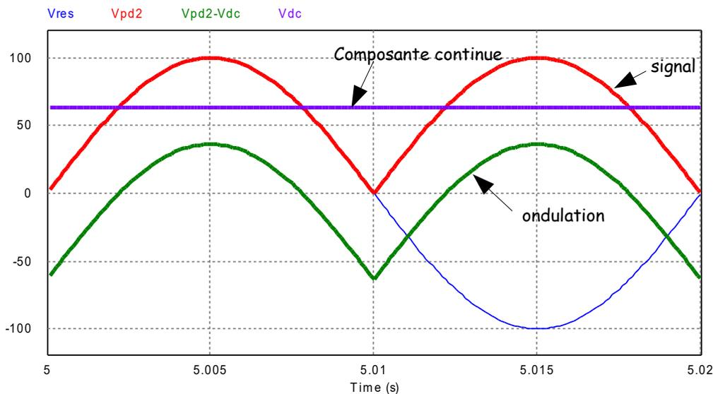
figure 1: tension réseau, tension en sortie de PD2, composante continue et ondulation de cette tension redressée
