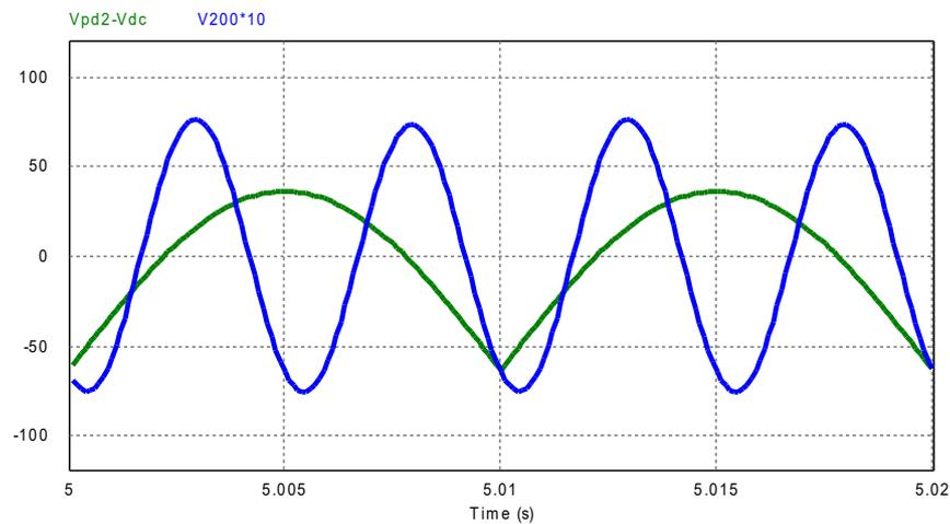
figure 3: ondulation et seconde sinusoïde amplifiée
