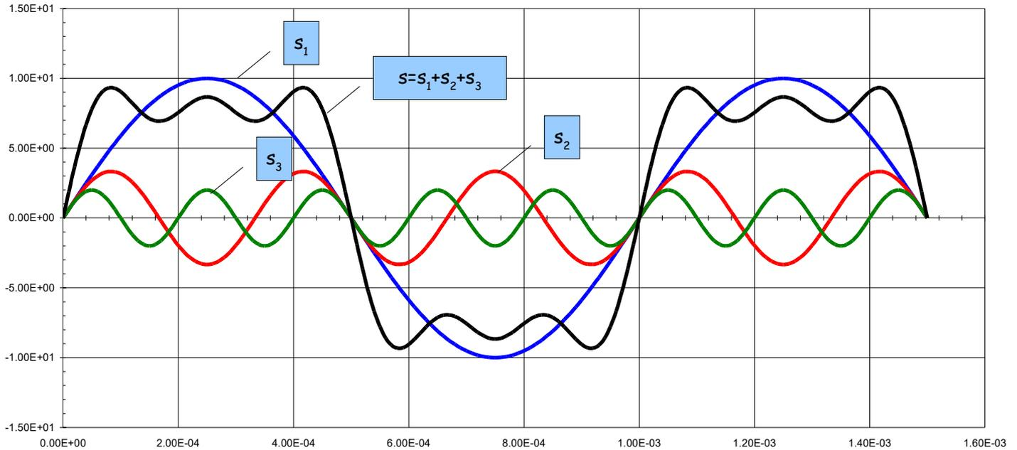
Lorsqu'on ajoute ces 3 sinusoides de fréquences et d'amplitudes bien précises, on fabrique un signal d'allure rectangulaire.
