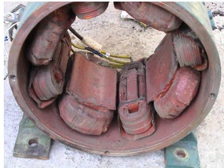
photo 1: stator d'une Mcc
