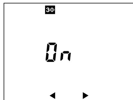
Figure 20 : Dans cet exemple, les calculs concernant le réseau triphasé équilibré sont activés.
