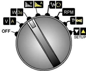
Figure 17 : Le commutateur rotatif en position  $W_{3\phi}$ .
