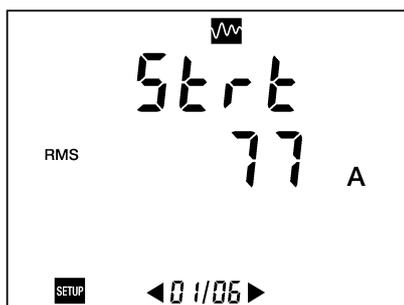
Figure 44 : Affichage du paramètre relatif au courant de départ.
