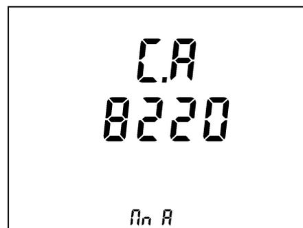
Figure 66 : Le deuxième écran à la mise en marche (avec indication du capteur de courant connecté).
