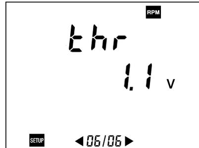
Figure 49 : Affichage du paramètre relatif à la tension de seuil du capteur tachymétrique.
