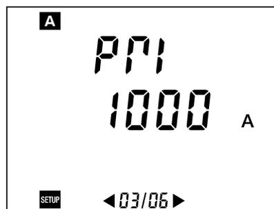
Figure 46 : Affichage du paramètre relatif au courant efficace primaire du transformateur d'intensité.
