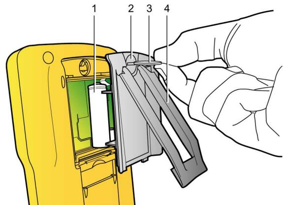
Figure 4 : Accès aux éléments de la batterie.
