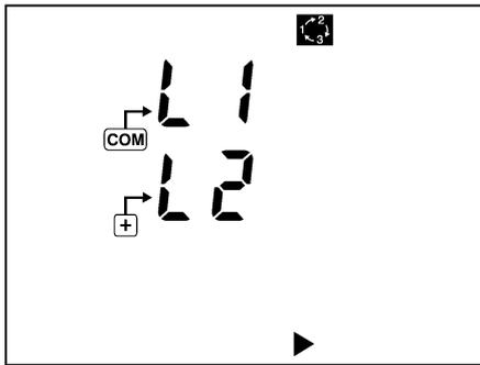
Figure 33 : Le C.A. 8220 est prêt pour la première mesure de détermination de l'ordre des phases.
