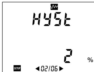
Figure 45 : Affichage du paramètre relatif à l'hystérésis.
