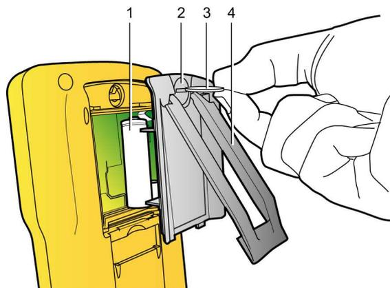
Figure 71 : Accès aux éléments de la batterie.
