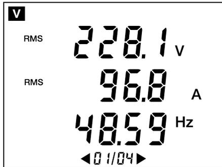
Figure 67 : Exemple de troisième écran (fonction de la position du commutateur rotatif).
