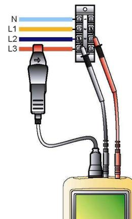
Figure 70 : Connexion en triphasé équilibré.
