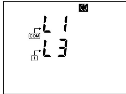
Figure 35 : Le C.A. 8220 est prêt pour la seconde mesure de détermination de l'ordre des phases.
