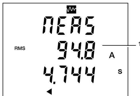
Figure 31 : Le chronomètre (bas de l'écran) est actif tout le temps que le seuil de courant bas n'est pas atteint.
