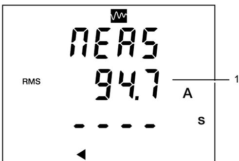
Figure 30 : Le C.A. 8220 attend le dépassement du seuil de déclenchement du courant de démarrage.
