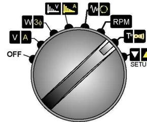
Figure 40 : Le commutateur rotatif en position **T°**.
