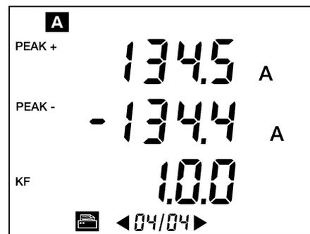
Figure 58 : L'icône d'imprimante clignote durant le transfert des informations vers l'imprimante thermique série.
