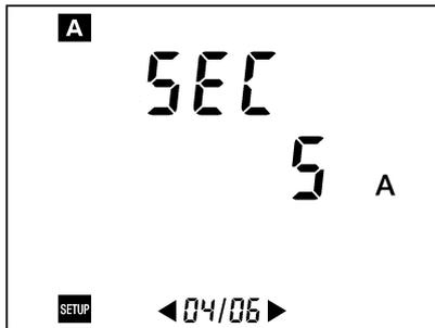
Figure 47 : Affichage du paramètre relatif au courant efficace secondaire du transformateur d'intensité.
