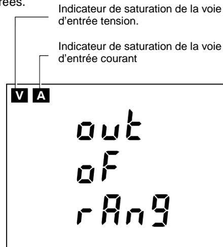
Figure 73 : Indicateurs de voies d'entrée saturées.
