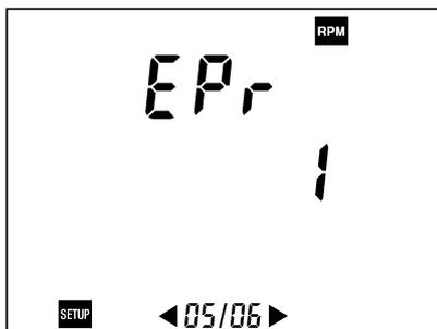
Figure 48 : Affichage du paramètre relatif au nombre d'événement par tour du signal tachymétrique.
