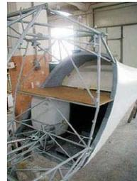
La structure **semi monocoque** est formée de cadre, rejoints par des raidisseurs
