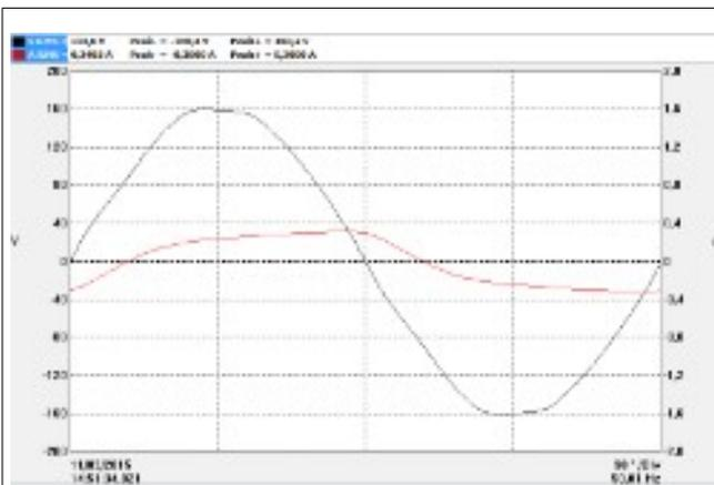
courbe 1: Transformateur non saturé - courant magnétisant "aplatit" / tension
