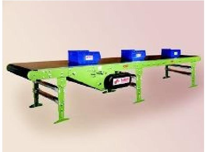
En fonctionnement de pleine charge, la masse sur le tapis est de 320kg et le tapis exerce une force résistante de 450N sur le tambour.
