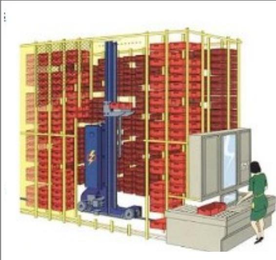
Un système Transgerbeur ou Transtockeur est un magasin automatisé dont les caisses référencées peuvent être stockées et destockées automatiquement sur ordre d'un opérateur.
