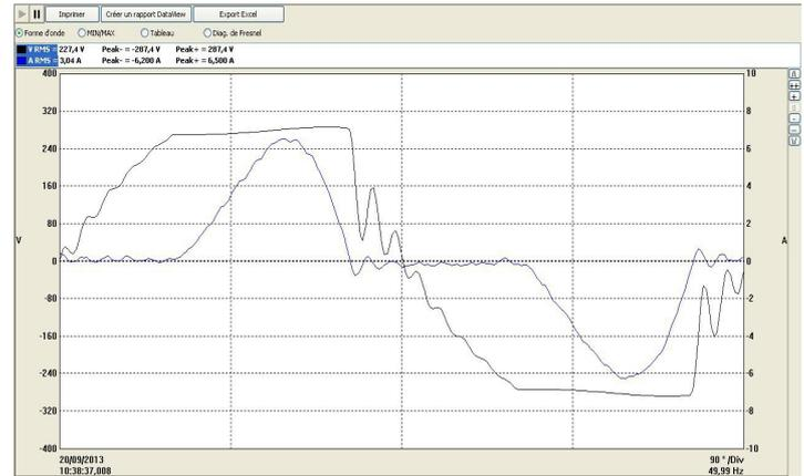
figure 6: tension et courant coté charge non linéaire
